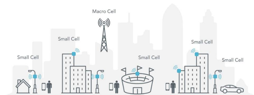
Slika 19 - Ilustrativni prikaz funkcioniranja Mreže malih ćelija
