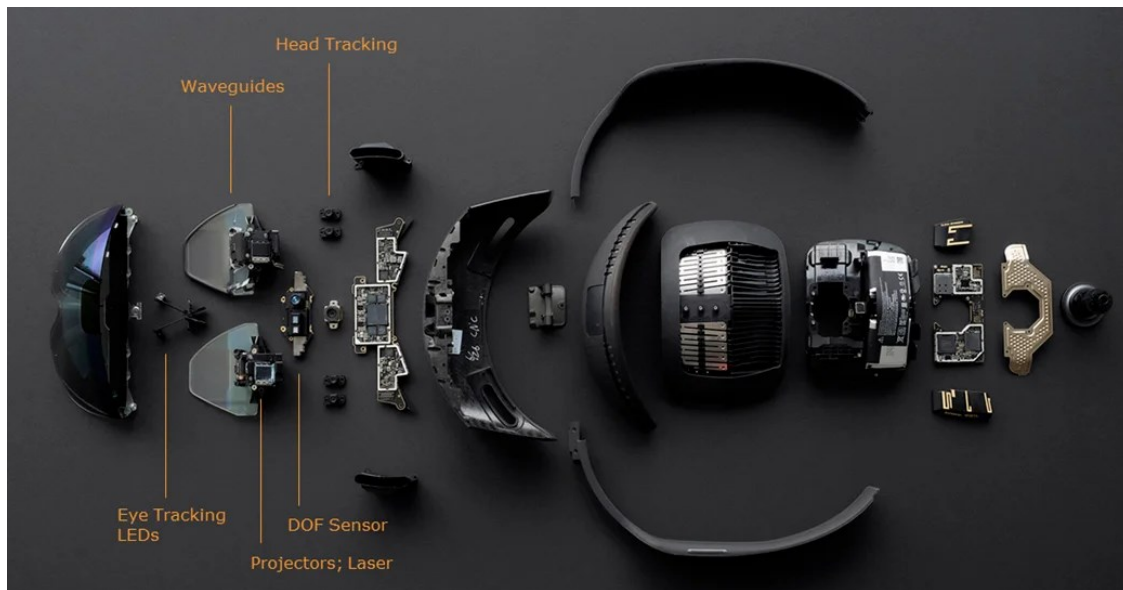
Slika 3 Prikaz glavnih optičkih komponenti Microsoft Hololens 2 naočala za proširenu stvarnost
