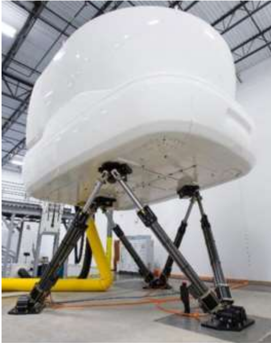
Slika 2. 1 Moderni simulator leta za obuku pilota putničkih zrakoplova
