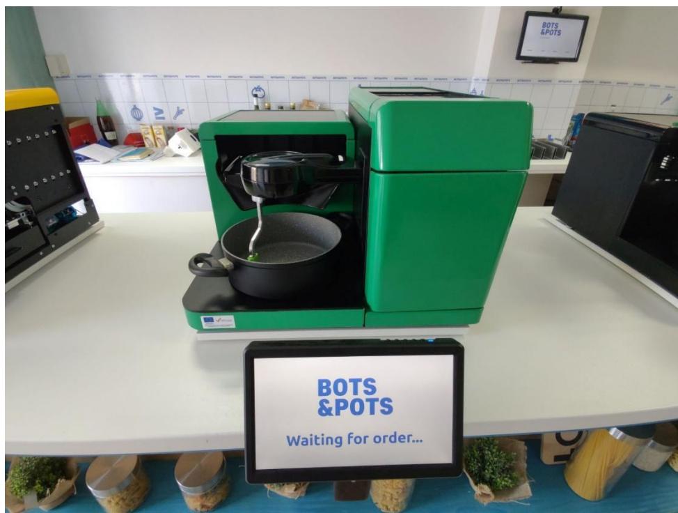
Slika 3. Jedan od robota koji priprema hranu u restoranu Bots&Pots
