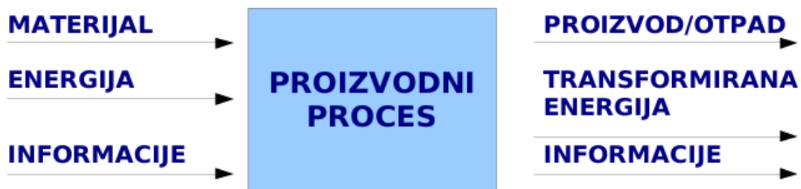
Slika 4. Shematski prikaz proizvodnog procesa (izvor: Mikac, T., Blažević, D., (2007.) Planiranje i upravljanje proizvodnjom, Rijeka,)
