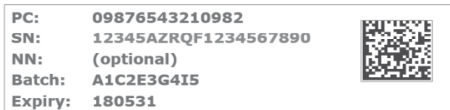
Slika 10 Prikaz 2D barkoda – serijalizacija na pakiranju Izvor: Strugar (2016)
