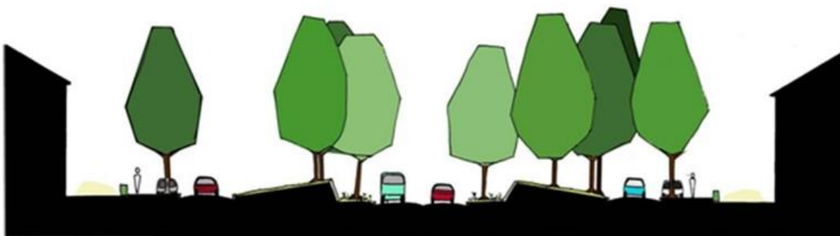
Slika 31. Smanjenje buke primjenom tihog asfalta i zelenih barijera
