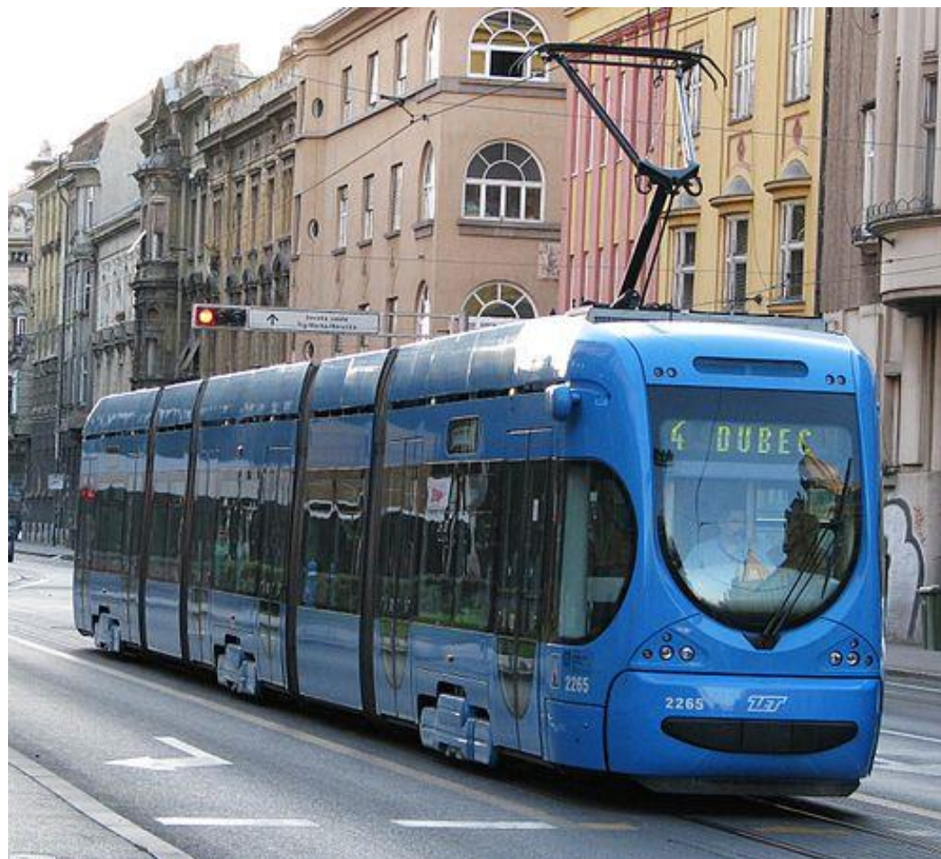
Slika 7: Moderni niskopodni tramvaj domaće proizvodnje (model TMK 2200)
