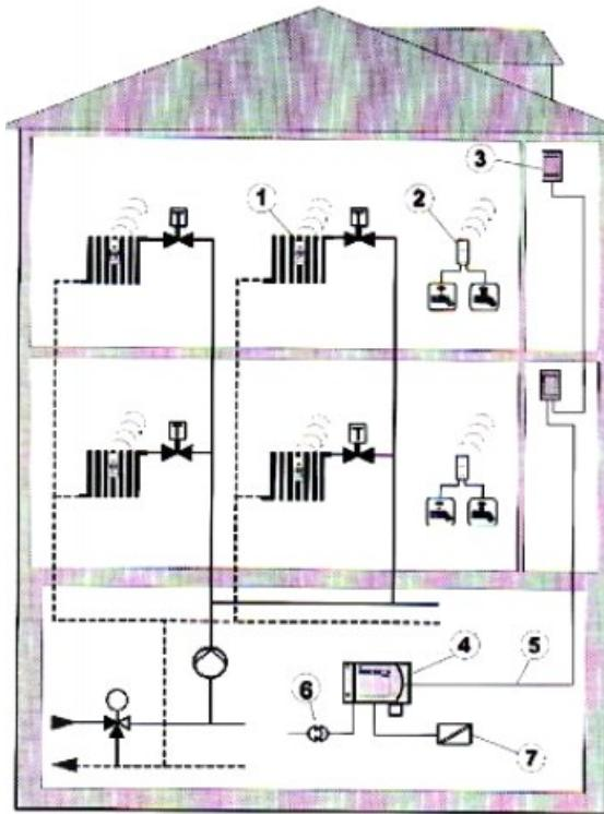
Legenda: 1-elektronski razdjelnik topline; 2-impulsni adapter; 3-antena; 4-centralna jedinica; 5-koaksijalni kabel
