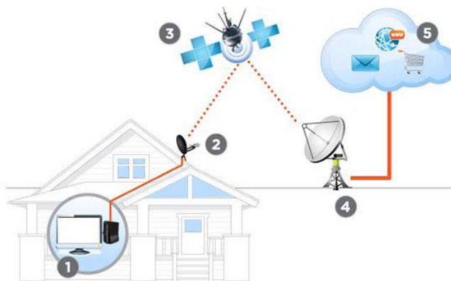
Slika 8 - Shematski prikaz dvosmjerne satelitske internet komunikacije
