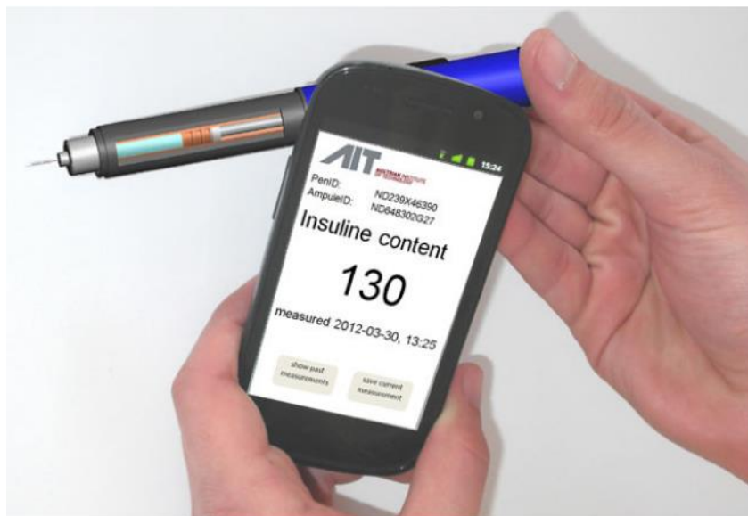
Slika 2 Mjerenje razine punjenja inzulinskog uložka u brizgalici za samo injektiranje pametnim telefonom s NFC-om pomoću novo razvijenog sustava.
