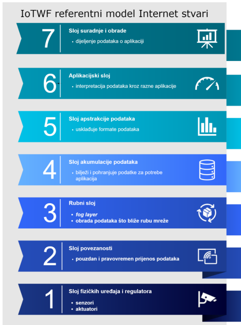
Slika 3. IoTWF referentni model IoT-a
