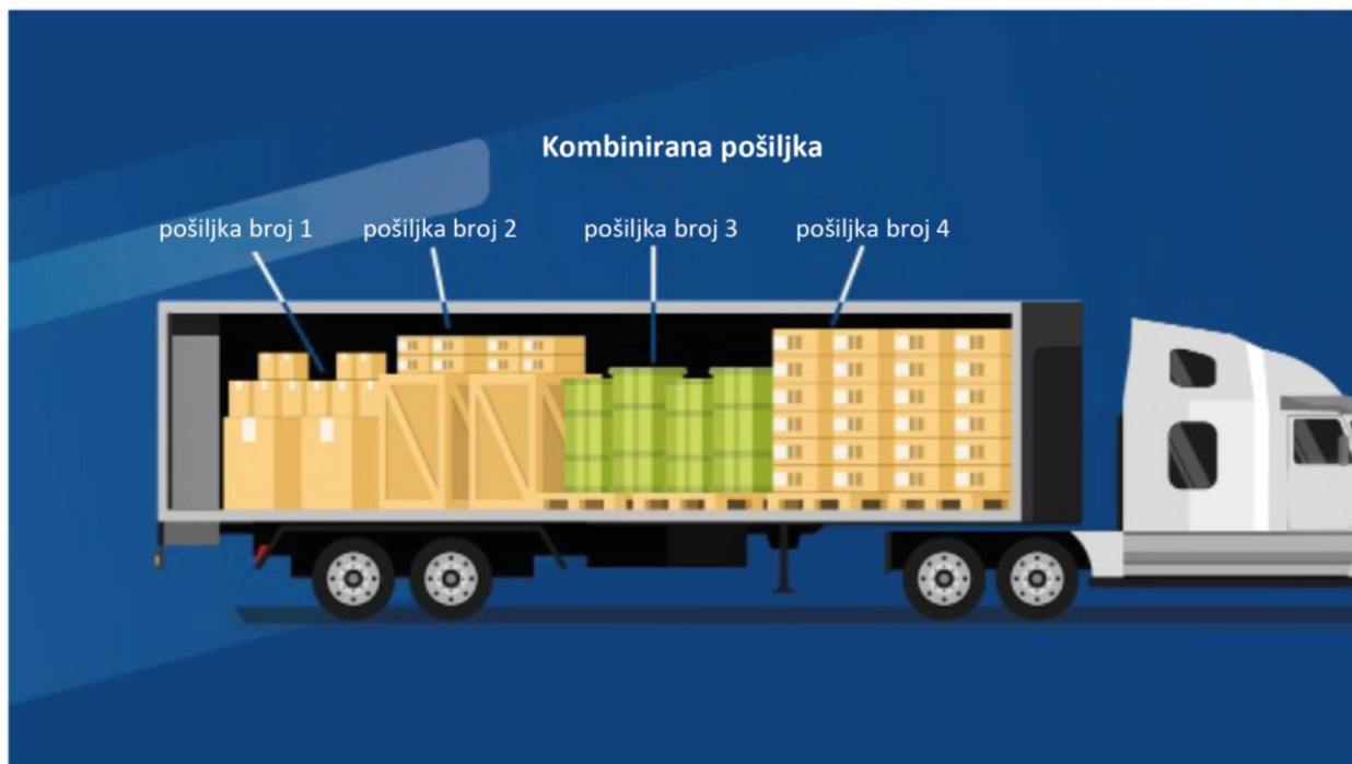
Slika 12. Prikaz organizacije/optimizacije utovara robe na kamion s više adresa isporuka
