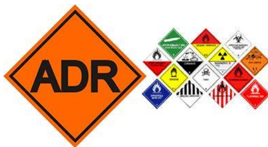
Slika 25. ADR oznake za označavanje vozila pri transportu opasne robe
