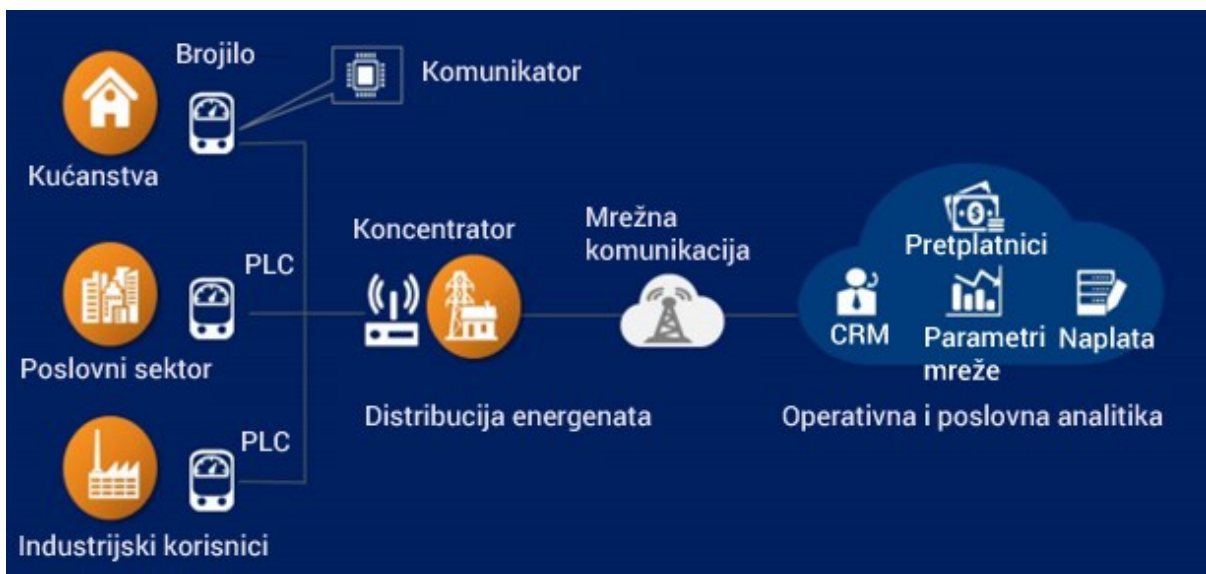
Slika 12. Komponente sustava za očitavanje električne energije
