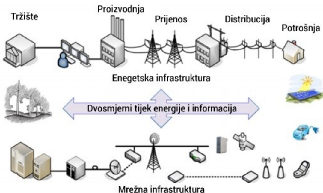
Slika 10. Dvosmjerna komunikacija AMI sustava
