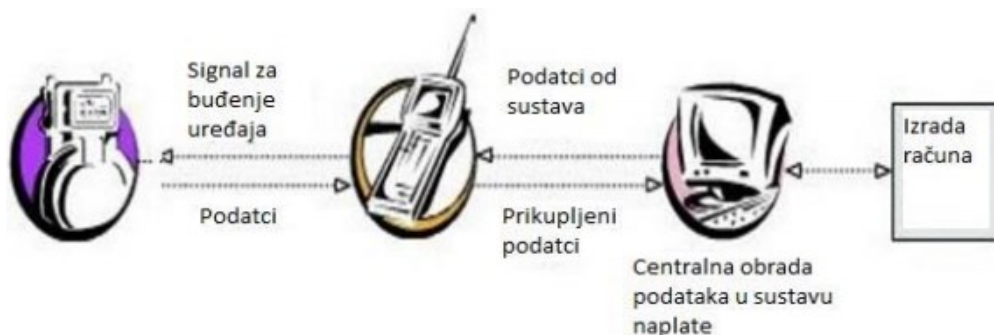
Slika 13. Princip daljinskog očitavanja s ručnim mjeračem
