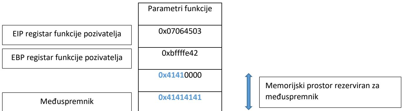
Slika 5. Model stoga prije stack buffer overflow napada
