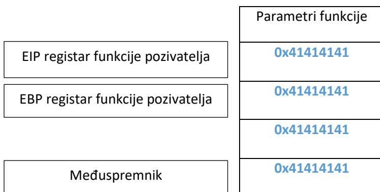
Slika 6. Model stoga nakon stack buffer overflow napada
