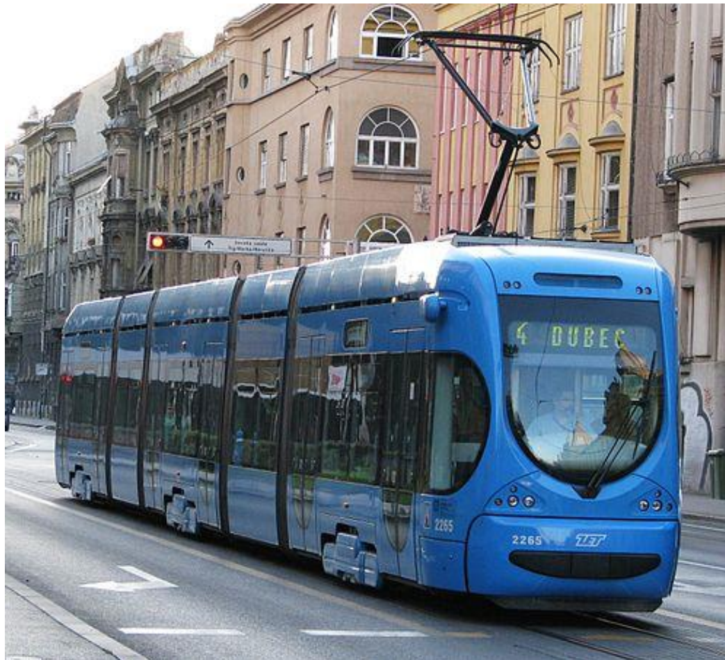
Slika 7: Moderni niskopodni tramvaj domaće proizvodnje (model TMK 2200)
