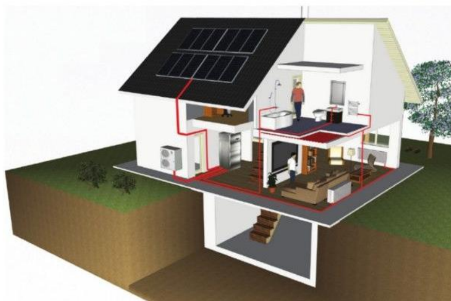
Slika 2. Prikaz rada zračne toplinske pumpe u obiteljskoj kući
