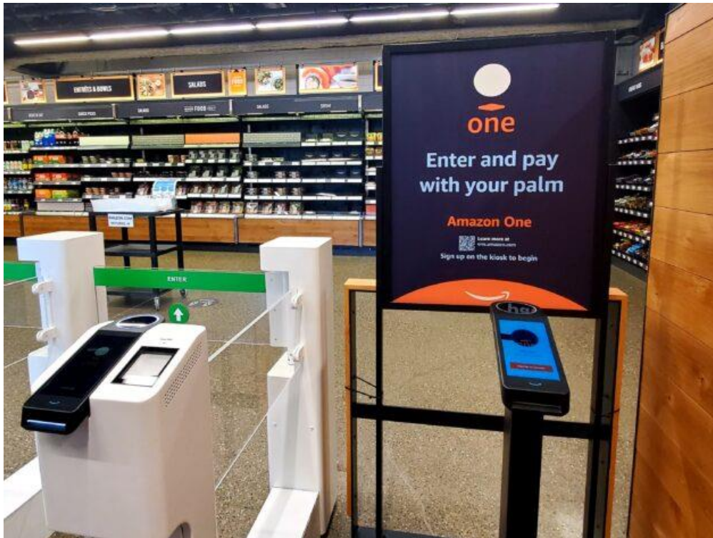
Slika 18: Amazon One registracijski skener (desno) i ulazni skener (lijevo)
